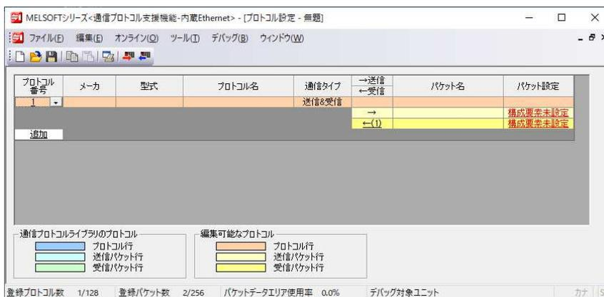
「追加」を押し「プロトコル追加」画面を開き、「新規追加」で以下のように通信プロトコルを追加する。
