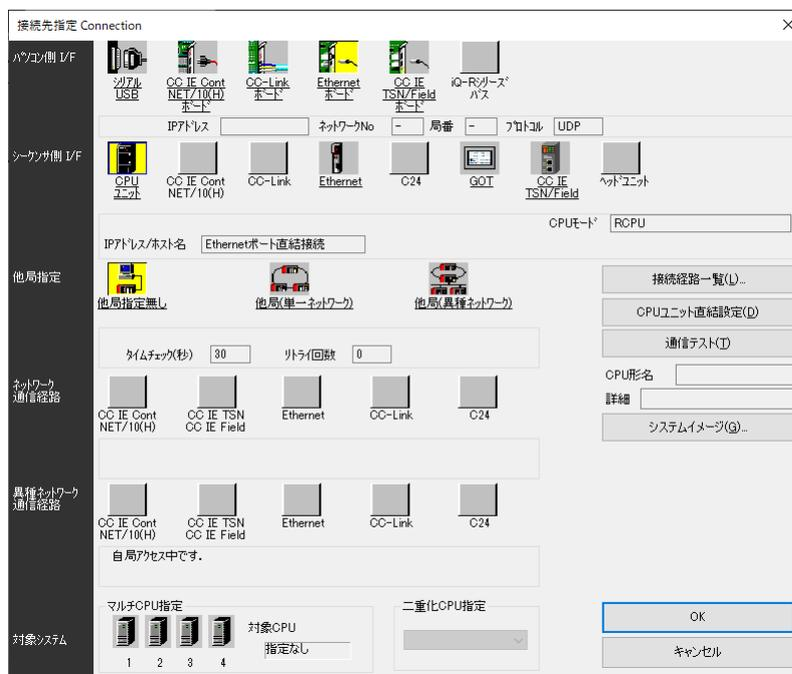
「CPU ユニット」をダブルクリックし、「シーケンサ側 I/F CPU ユニット 詳細設定画面」を開く。
